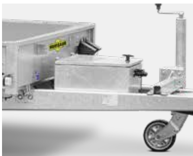
Deichselbox zum Schutz der Batterie und der Absenkhdraulik
