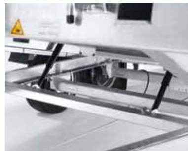
Brücke mit speziellem Kipplager
