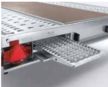
Im Bohlenschacht einschiebbare feuerverzinkte Stahlbohlen
