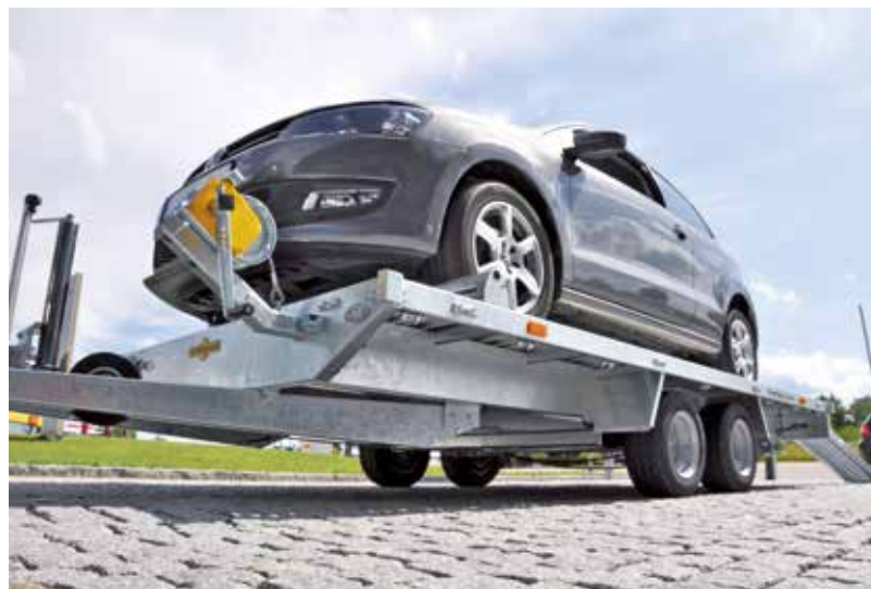
Stabiler Grundrahmen aus gekanteten Stahlprofilen
